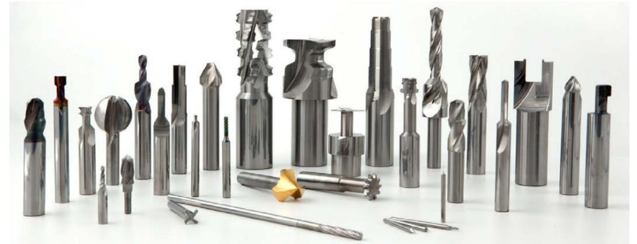
TN Værktøjslibning produit une gamme complète de fraises à grande vitesse, de forets étagés et de fraises de forme sur mesure
