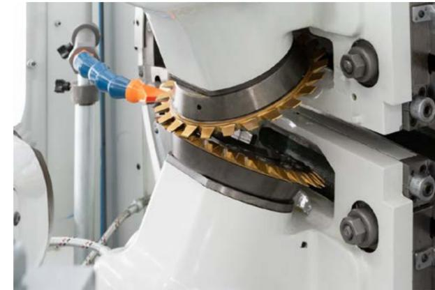
Le projet s'est concentré sur la conception des deux têtes de fraise (entraînées à l'origine par un seul moteur) en y insérant deux moteurs afin d'obtenir une vitesse plus élevée
