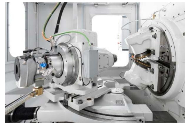
La coopération entre NUM et Lanzi existe depuis longtemps et s'est renforcée au fil du temps grâce à divers projets. Le projet le plus récent est la modernisation d'une ancienne machine à tailler les engrenages coniques pour la coupe de dents droites
