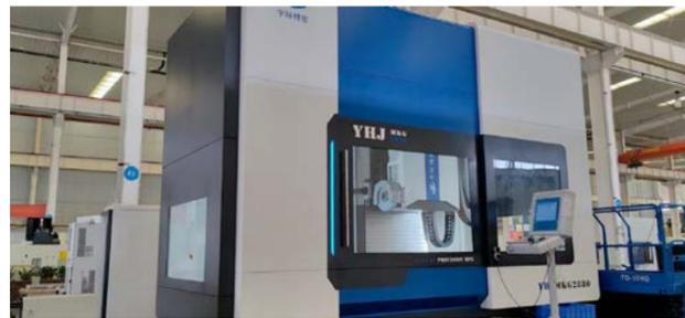
YHJMK2880, une rectifieuse verticale universelle CNC de haute précision
