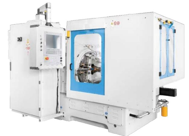
L'objectif de Lanzi avec le retrofit de cette machine à tailler les engrenages est précisément de réaliser l'usinage avec des fraises en carbure
