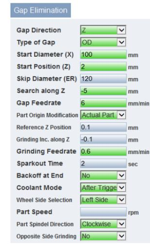
Figure 5: Masque de saisie des données d'élimination des écarts dans l'IHM NUMgrind
