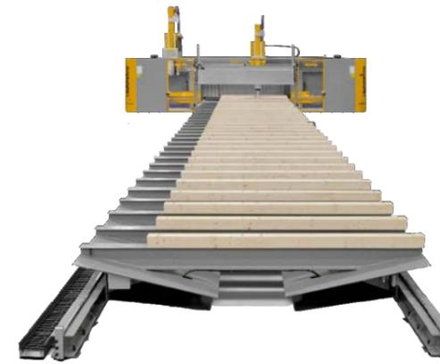
Un exemple concret de la collaboration entre Essetre et NUM est le Techno Multiwall, un centre d'usinage CNC pour le traitement de grandes poutres en bois
