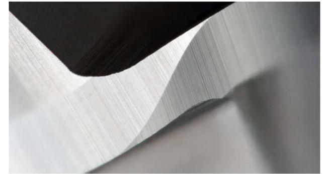
Figure 2 L'arête de coupe transversale mesurée avec le microscope numérique de Keyence (grossissement 200:1)
