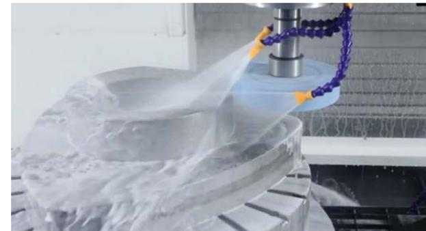
Rectification du profil excentrique du diamètre extérieur
