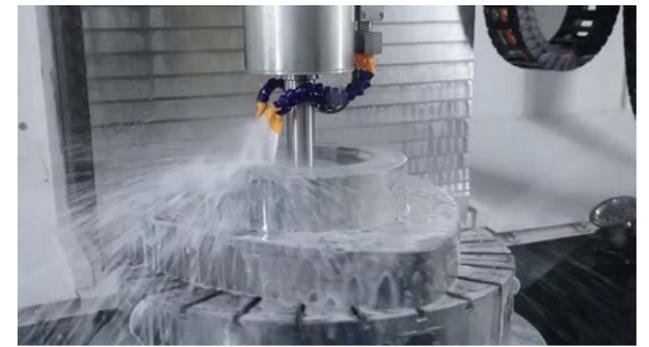
Rectification du profil du diamètre intérieur
