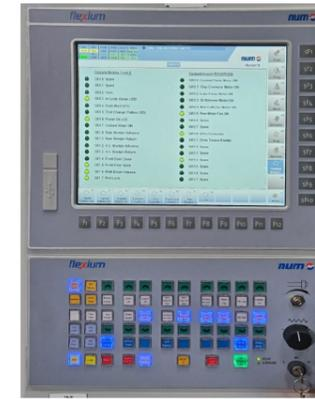
IHM 12" FS122 écran tactile avec panneau de machine MPo8 tous programmés sur mesure dans l'automate y compris les écrans de visualisation pour la programmation et l'opération
