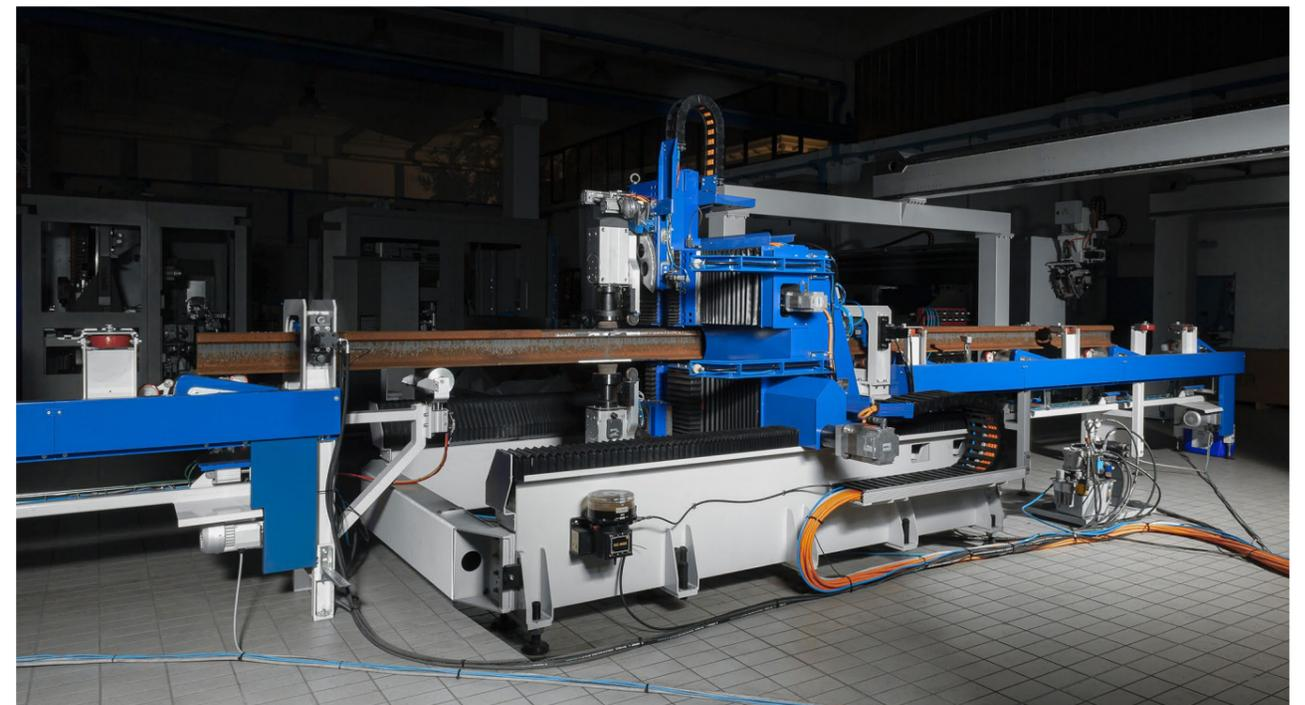
Provide Solution baute eine vollautomatische, 200 Meter lange Schweissanlage für Schienenteile
