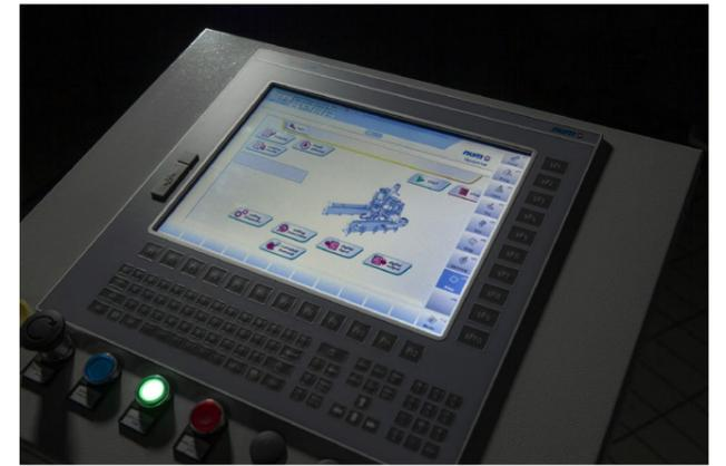
Bei dem von NUM gelieferten System handelt es sich um eine Flexium+ 68, komplett mit digitalen Antrieben der MDLUX-Reihe, bürstenlosen Motoren in Einkabelauführung und ausgestattet mit Absolutwertgebern
