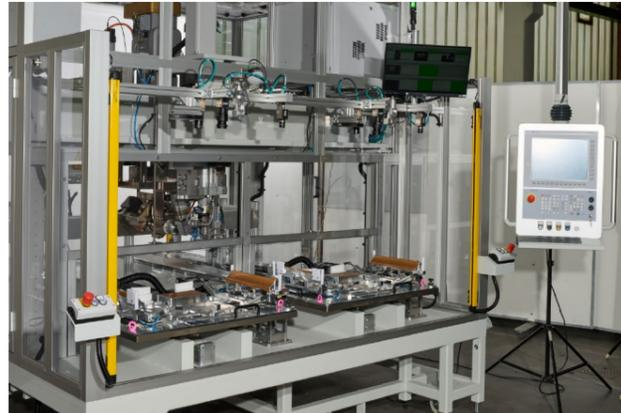
Heissprägemaschine mit einer Flexium<sup>+</sup> 68 Steuerung. Zwei Einzugschubtische inkl. 8 Kameras zur Qualitätsüberwachung
