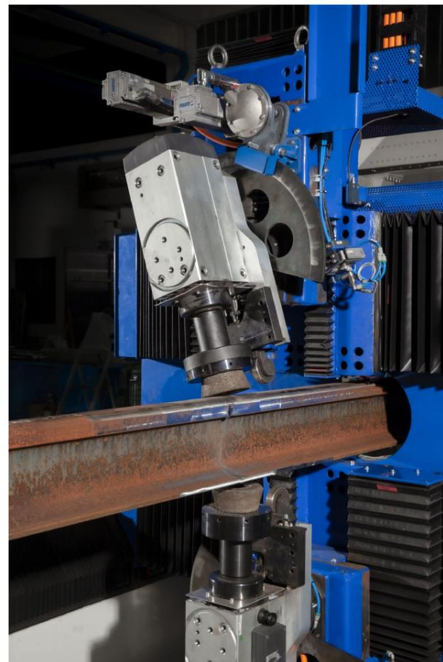
Die Maschine zur Entfernung von Schweiß- und Schleifrückständen wurde vollständig von Provide Solution mit Hilfe von NUM entwickelt und hergestellt
