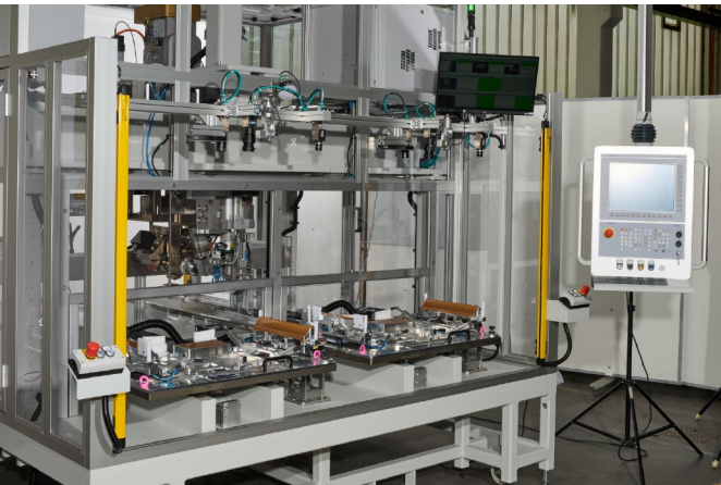
Machine de marquage à chaud avec une commande Flexium + 68. Deux tables d'insertion et 8 caméras pour le contrôle qualité.
