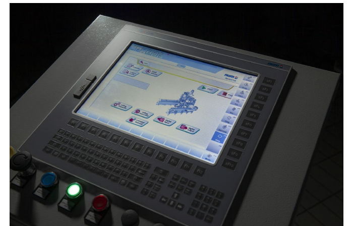
Le système fourni par NUM est un Flexium+ 68, équipé de variateurs numériques de la gamme MDLUX, de moteurs sans balais en version monocâble et de codeurs absolus
