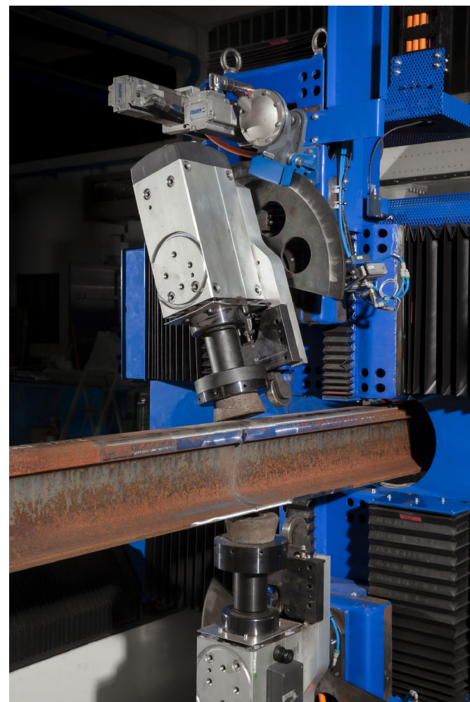
La machine d'élimination des résidus de soudure et de meulage a été entièrement conçue et fabriquée par Provide Solution avec l'aide de NUM
