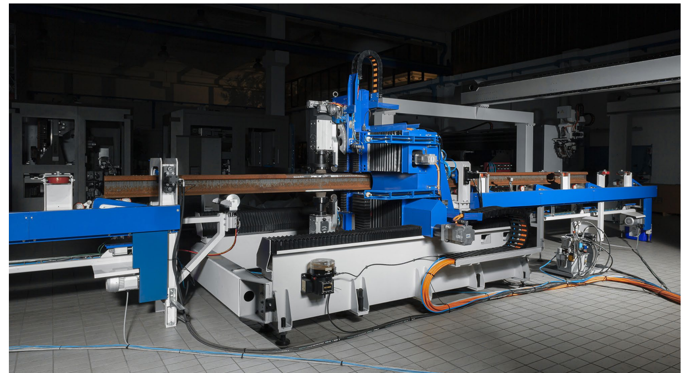
Provide Solution a construit une installation de soudage de pièces de chemin de fer entièrement automatisée, d'une longueur de 200 mètres
