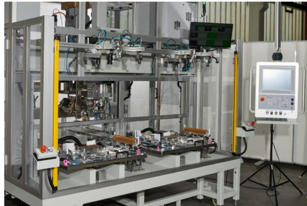
Macchina per la stampa a caldo con sistema di controllo Flexium+ 68. Due tavoli scorrevoli con 8 telecamere per il monitoraggio della qualità.
