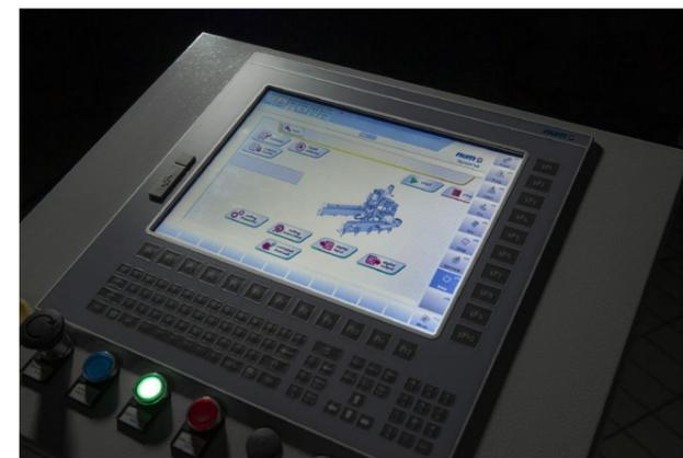
Il sistema fornito da NUM è un Flexium+ 68, completo dei drive digitali della gamma MDLUX, motori brushless nella versione cavo unico ed equipaggiati da encoder assoluti
